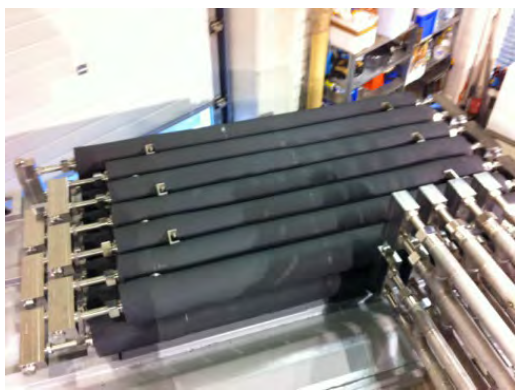
HP160製プレクーラー 岩谷産業 HP160とXM-19（HRX19）の 耐水素脆性の発見
